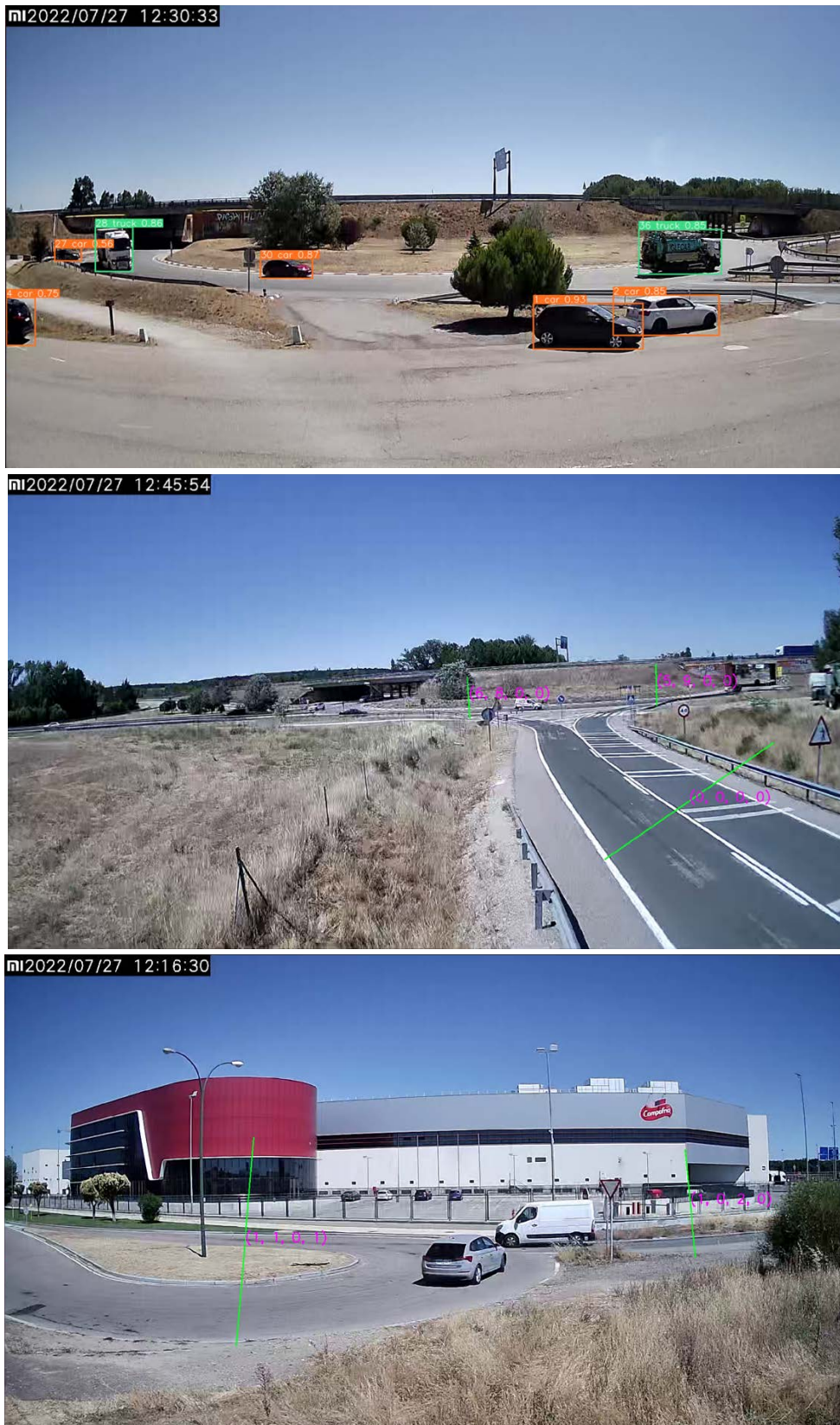
Ilustración 7 Conteo automático de vehículos empleando reconocimiento de imagen
